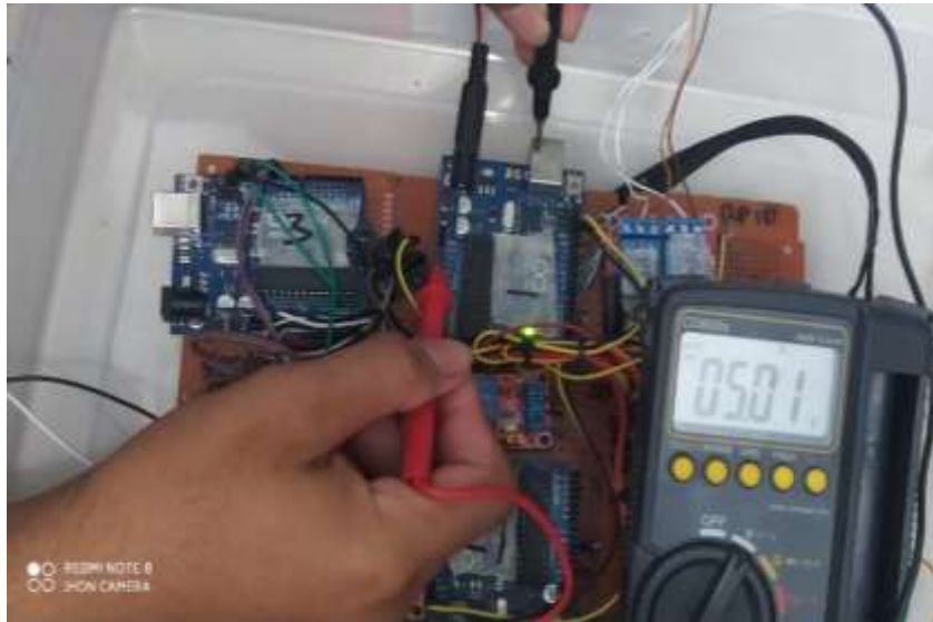
Gambar 4. 2 Pengukuran Tegangan 5v Pada Arduino Uno
