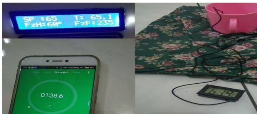
Gambar 4.8 Pengujian Suhu Dallas 65 °C dan Termometer 61.4 °C Sumber : Ahmad Ikhwari, 2020
