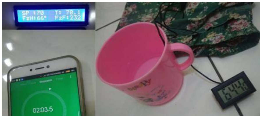
Gambar 4.9 Pengujian Suhu Dallas 70 °C dan Termometer 64.4 °C Sumber : Ahmad Ikhwari, 2020
