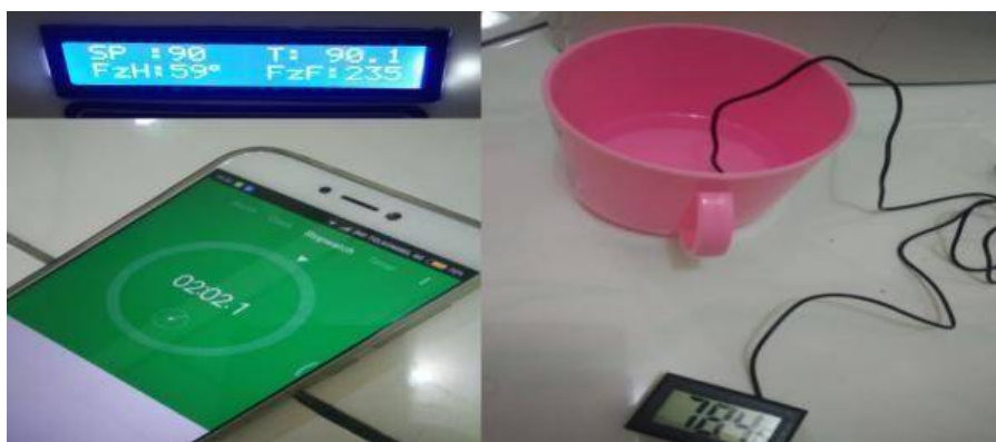
Gambar 4.13 Pengujian Suhu Dallas 90 °C dan Termometer 78.4 °C Sumber : Ahmad Ikhwari, 2020
