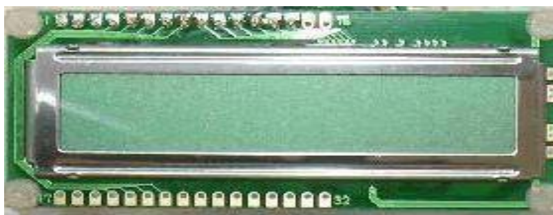
Gambar 2.7 Modul LCD Karakter
