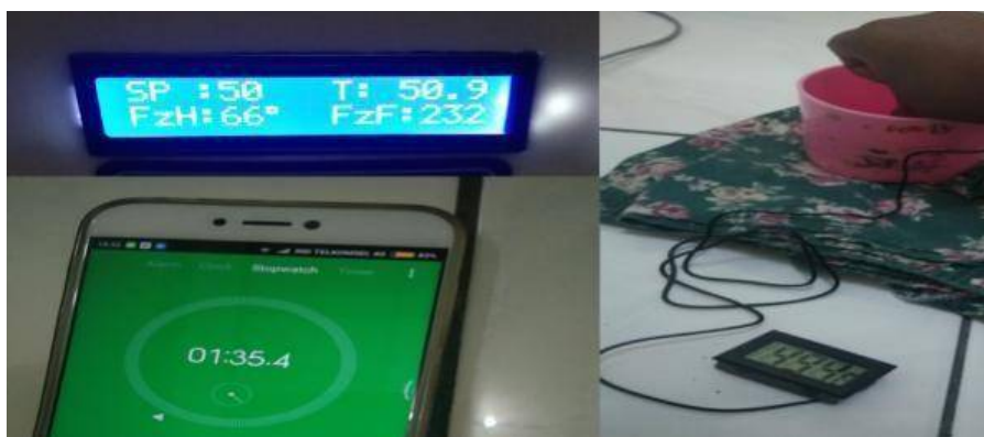
Gambar 4.5 Pengujian Suhu Dallas 50 °C dan Termometer 44.4 °C Sumber : Ahmad Ikhwari, 2020
