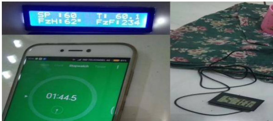
Gambar 4.7 Pengujian Suhu Dallas 60 °C dan Termometer 57.0 °C Sumber : Ahmad Ikhwari, 2020
