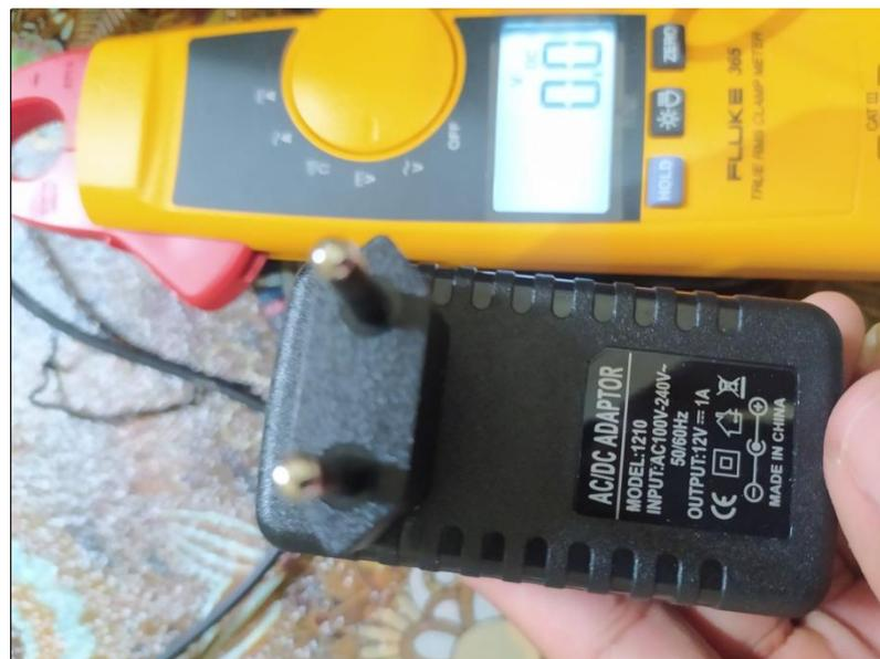
**Gambar 4.3.** Spesifikas tegangan *output power supply*
