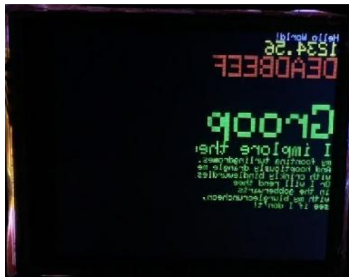
Gambar 4.2. Gambar Pengujian LCD TFT
