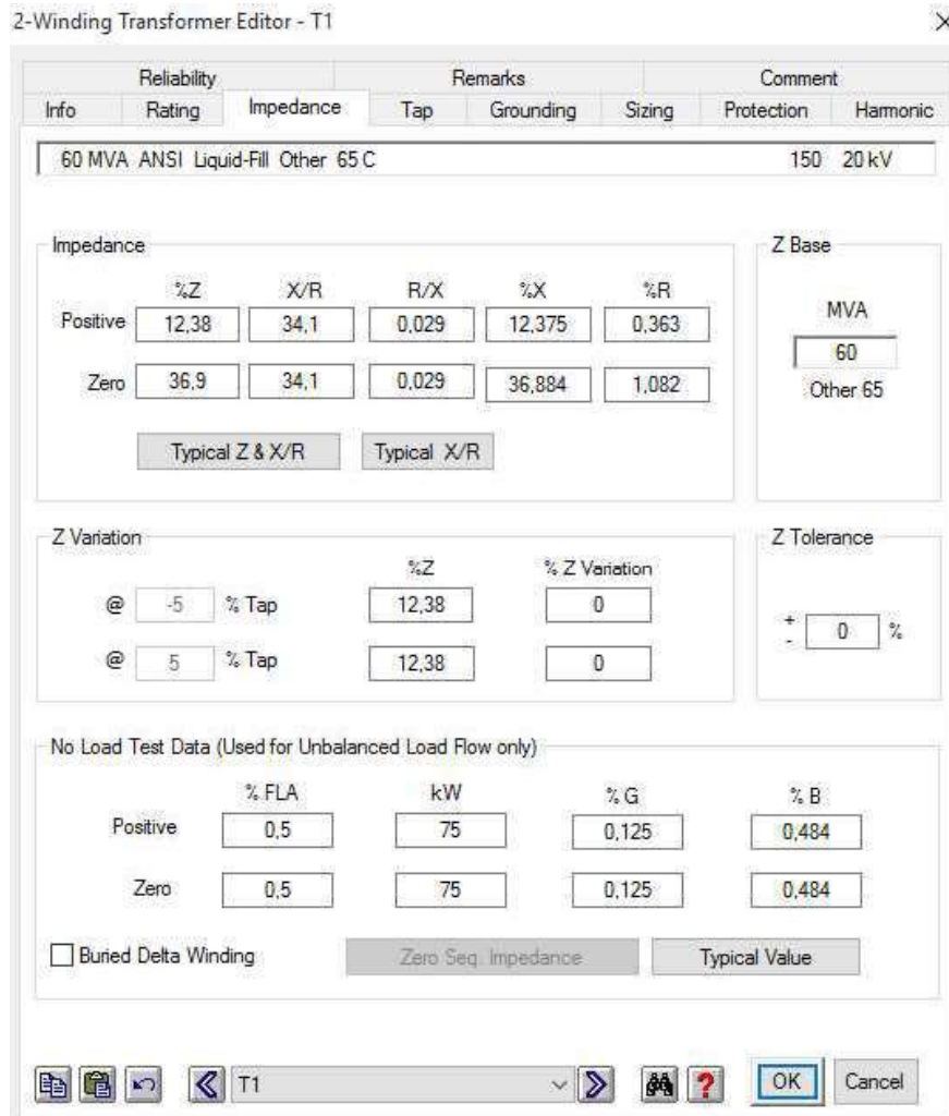
Gambar 4.17 Setting Impedansi Transformator Step Down 60 MVA Sumber: Penulis, 2020
