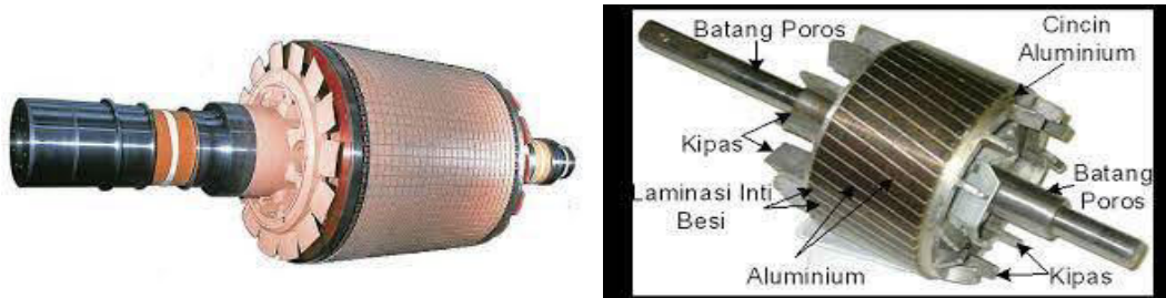
Gambar 2.8 Bagian – Bagian Rotor Sangkar
