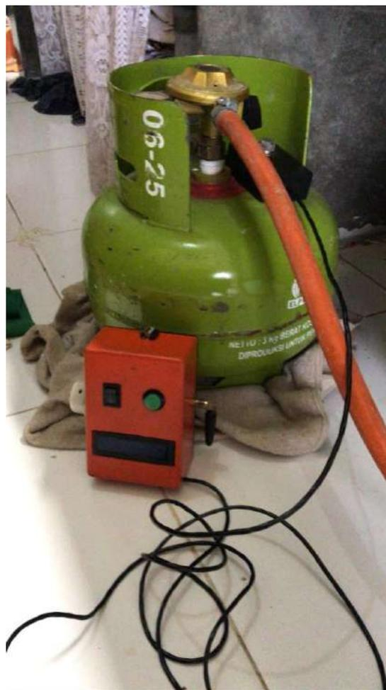
**Gambar 4.20** Contoh Peletakan Sensor Untuk Mendeteksi Kebocoran Gas
