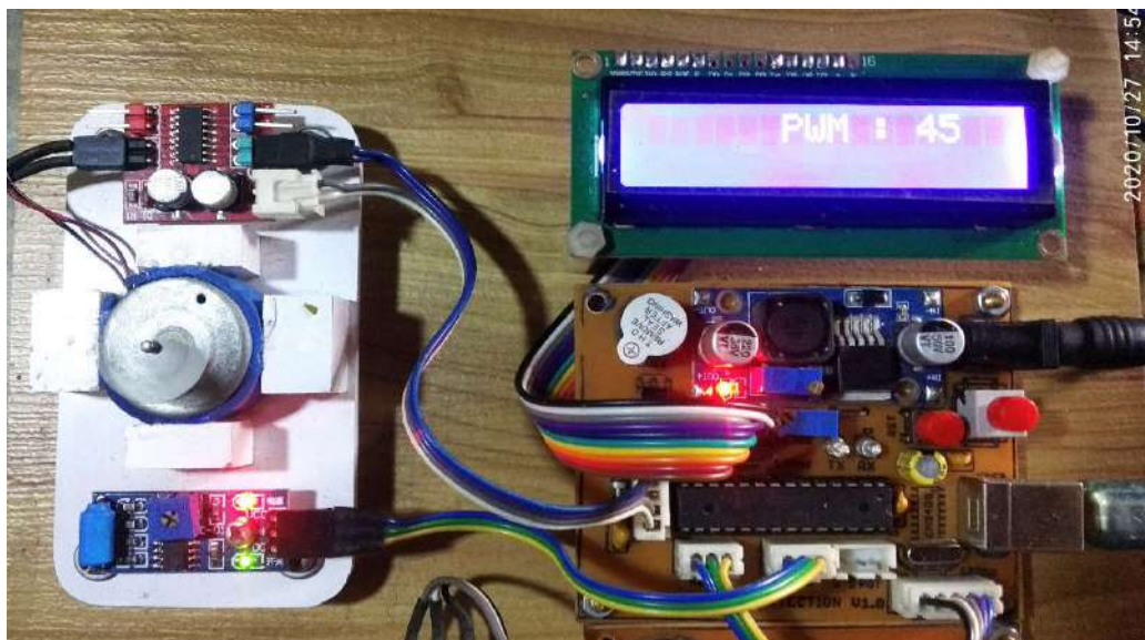
Gambar 4.10 Hasil Pengujian Motor DC Vibrator
