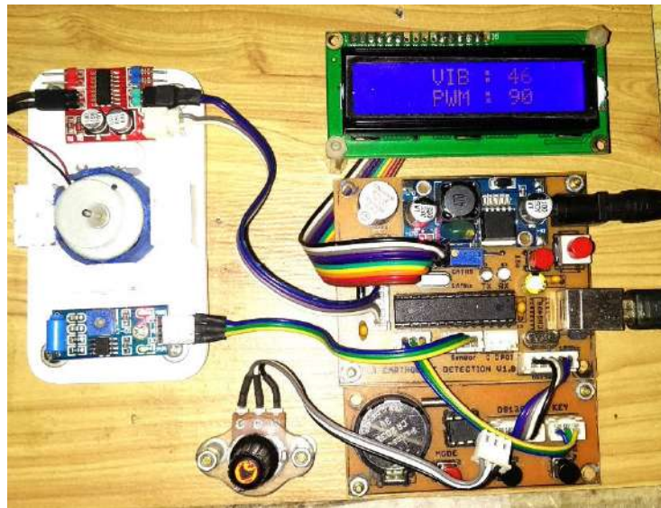
Gambar 4.11 Hasil Pengujian Sensor Getar SW-420
